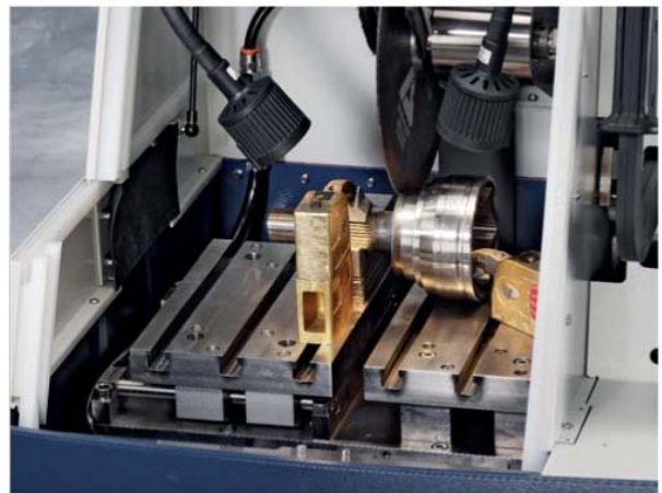
Скоростные тиски и подъемные блоки обеспечивают вертикальные усилия зажатия для образцов большого размера и неправильной формы.
