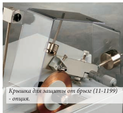
Для резки запрессованных образцов применяется специальный зажим и фланцы меньшего диаметра.
