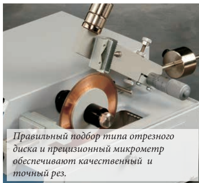
Для резки запрессованных образцов применяется специальный зажим и фланцы меньшего диаметра.
