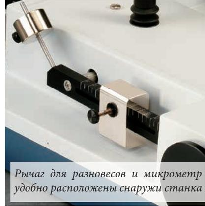
Рычаг для разновесов и микрометр удобно расположены снаружи станка
