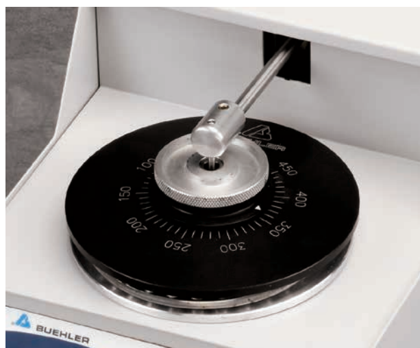
Насадка для прецизионного утонения для подготовки образцов к ПЭМ и РЭМ.
