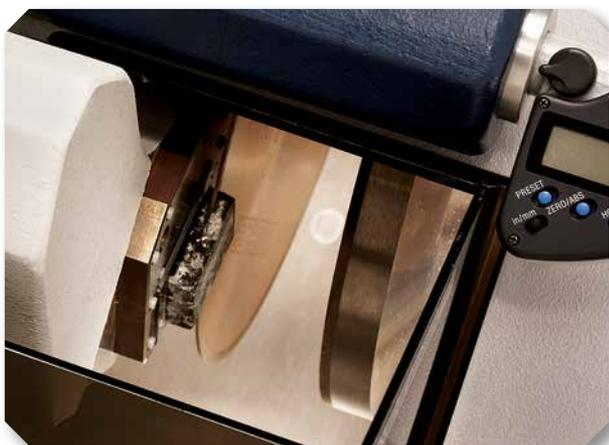
Образец, наклеенный на стекло обрезается алмазным диском. Шлифовальный диск (справа) предназначен для утонения образца без переустановки после этапа резки.
