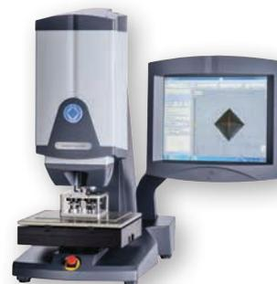
Система автоматического анализа изображения и оборудование для измерения твердости, включая: микроскопы, камеры, программное обеспечение, твердомеры, держатели образцов, меры твердости и программное обеспечение для измерения твердости.
