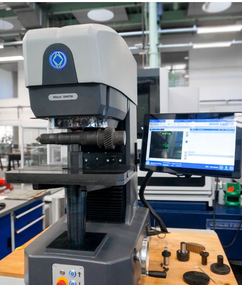
Твердомер UN4000 поставляется с удлинителем для опорных приспособлений
