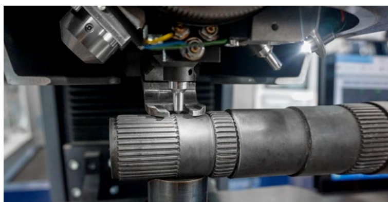
Если защитный экран осложняет доступ к образцу со сложной геометрической формой, его легко можно снять
