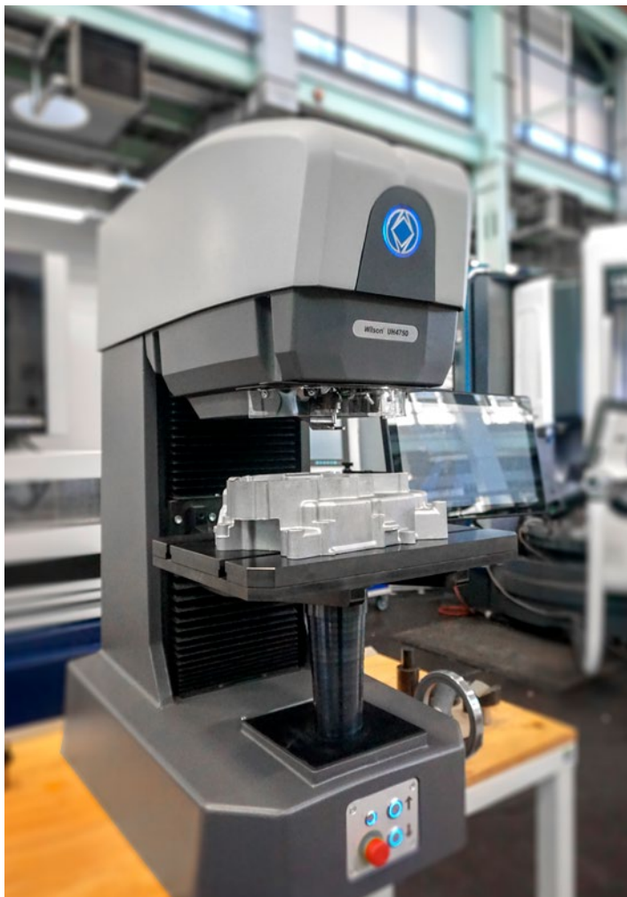
Испытание отливки из AlMgSi на твердомере Wilson UN4750
