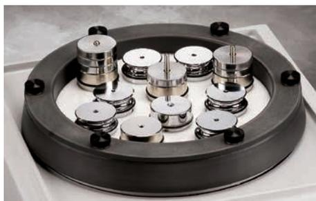
Полировальная чаша позволяет размещать до 18 запрессованных образцов одновременно
